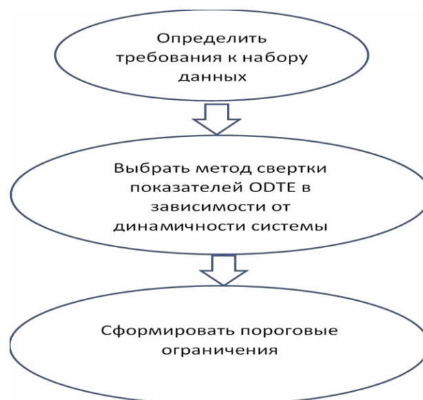
Рисунок 4 - Алгоритм оценки качества функционирования цифрового двойника (составлено автором) (полная блок-схема алгоритма размещена в диссертации, рис. 2.1.3)
